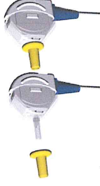
ภาพที่ 6 การสวม ear tip เข้ากับหัว probe tip OAEs
