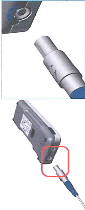
ภาพที่ 3 การต่อสาย probe เข้ากับเครื่องตรวจ
